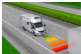
La telecamera e il radar consentono di mantenere la **velocità di viaggio impostata** e la **distanza necessaria dal veicolo davanti**. Se questo rallenta, il sistema riduce automaticamente la velocità per rispettare la distanza di sicurezza scelta.
