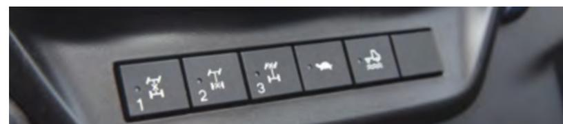
Trazione perfetta in qualsiasi situazione: con **tre bloccaggi differenziali** su asse anteriore e posteriore e un **blocco longitudinale** sulla scatola di trasferimento
