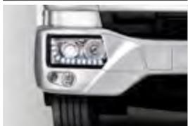
Per migliorare la sicurezza di guida e la visibilità, l'Eurocargo è dotato di serie di una **luce di marcia diurna LED (DRL)**. Opzionalmente sono disponibili anche i fari alogeni Xenon.
