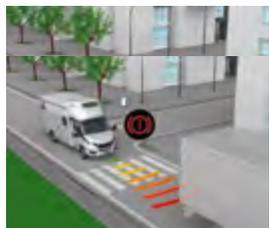
Grazie alla combinazione di telecamera e radar, l'assistente alla frenata d'emergenza (AEBS) riconosce **per tempo possibili collisioni** e frena in automatico. A velocità ridotte, questo consente di evitare del tutto **gli incidenti e funge da ammortizzatore in quelli** a velocità maggiori.
