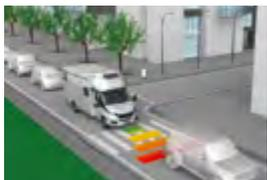
L'assistente agli ingorghi offre la **stessa funzionalità dell'ACC** ma per velocità **inferiori a 30 km/h**.
