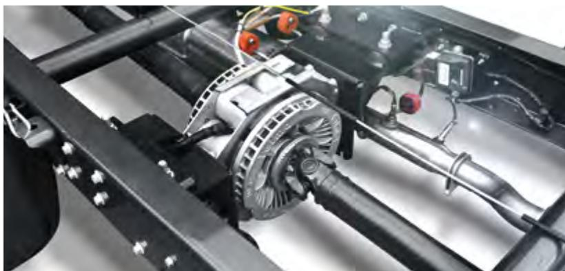
Azionando il pedale convenzionale del freno, si attiva sempre prima il Telma® Retarder. Senza che il conducente se ne renda conto, Telma® **acquisisce fino al 90% di tutti i processi di frenata** ed evita così il surriscaldamento del freno di servizio. Il freno a correnti parassite integrato garantisce **maggiore sicurezza e più comfort**, in particolare in discesa, in quanto l'impianto frenante di servizio rimane funzionante in caso di emergenza.
