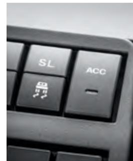
L'**Adaptive Cruise Control (ACC)** basato su radar adatta la velocità alla distanza di sicurezza desiderata al veicolo davanti. Con l'ausilio del radar il sistema monitora la distanza e, se necessario, interviene automaticamente, prima riducendo la coppia, poi azionando il freno motore e infine il freno di servizio.
